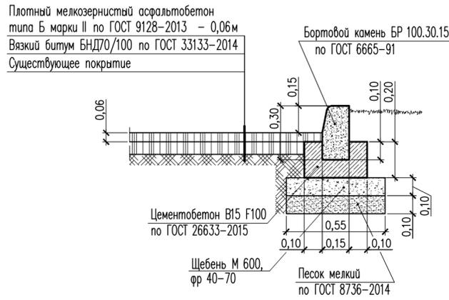
Конструкция дорожной одежды тротуара (тип 2)
