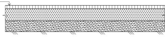
Мелкозернистый асфальтобетон типБ марка II по ГОСТ 9128-2013- 0,06м Подгрунтовка бутумной эмульсией ЭБК-1 -0,8 л/м²по ГОСТ Р 52128-2003 Щебень М 1000 фр. 40-70 с заклинкой щебнем фр. 5-10 из расчета 0,01 м³ на 1 м² по ГОСТ 8267—93 — 0,22м Песок мелкий по ГОСТ 8736-2014 — 0,18м
