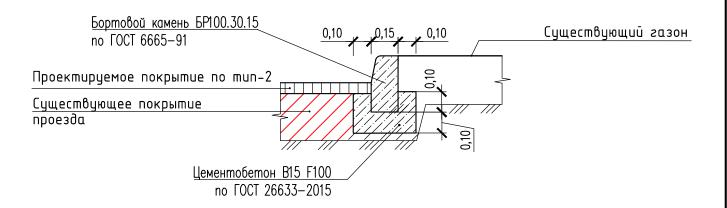
Конструкция установки бортового камня БР100.30.15 на участке сопряжения покрытий проезжей части и тротуара (L=30M).
